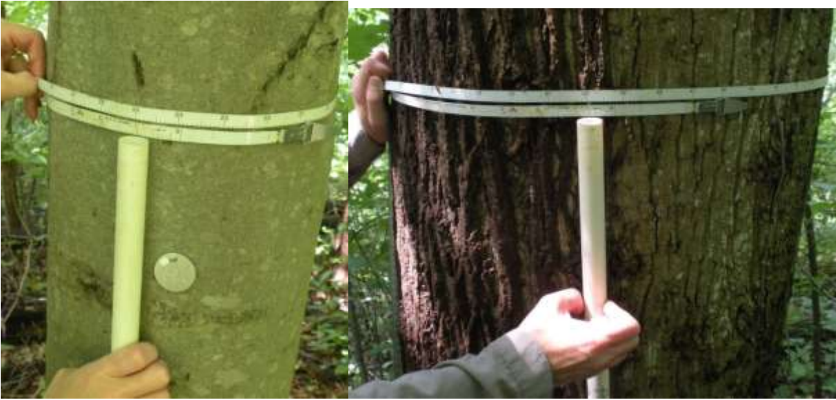
ຮູບສະແດງ 5: ການວັດແທກໜ້າຕ້າງໃຊ້ແມ່ດັກ້ແທກໜ້າຕ້າງ ແລະ ໄມ້ວັດແທກ (ທໍ່ PVC)
